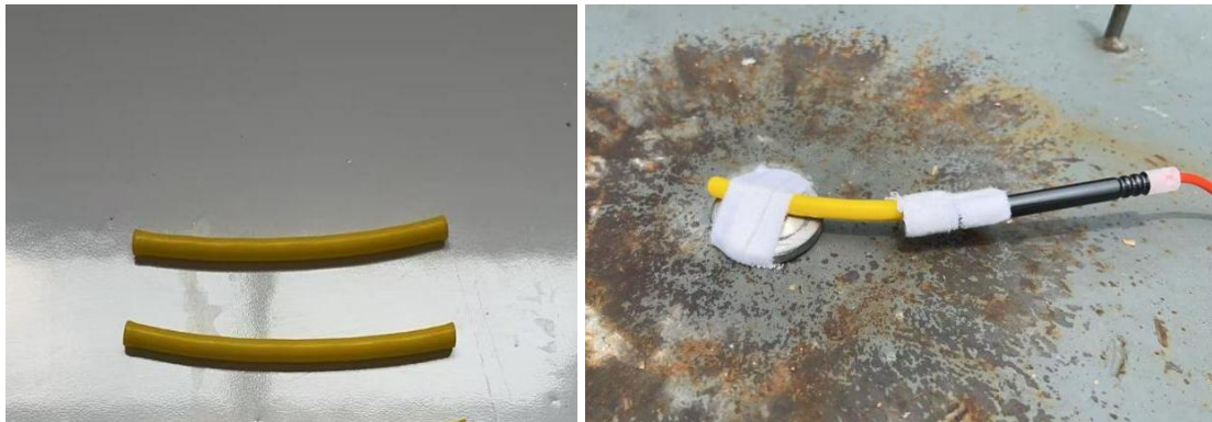
图 14 导爆索未浸水-空气中传爆试验前
