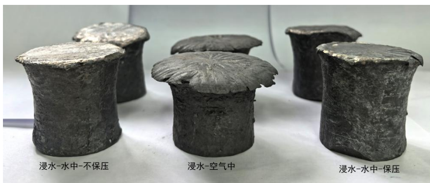
图 25 乳化炸药猛度试验后（铅柱上端面）
